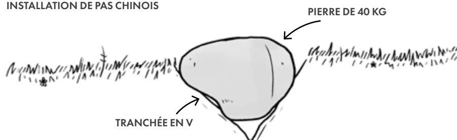
INSTALLATION DE PAS CHINOIS
